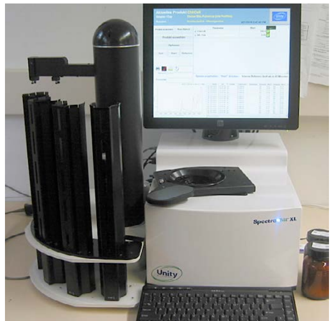
■ Bild: Das neue Nahinfrarotspektrometer des LKV Bayern. (Gerätehersteller: Unity Scientific GmbH)
