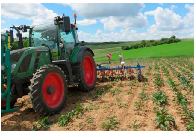
▣ Bild 1: Linien im Feld, die bei der Saat gezogen wurden, kann ein Traktor mit Kamerasteuerung oder GPS-RTK-Unterstützung genau abfahren. (Foto: Sabine Staub)
