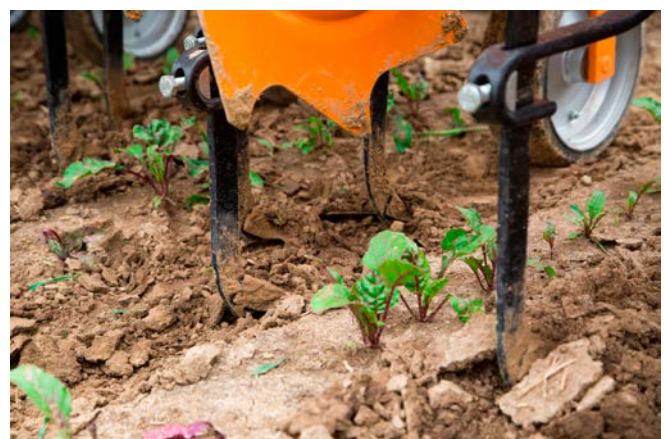
▣ Bild 2: Die oberen zwei bis drei Zentimeter des Bodens werden von Gänsefußscharen bearbeitet. (Foto: Meike Maser-Plag)
