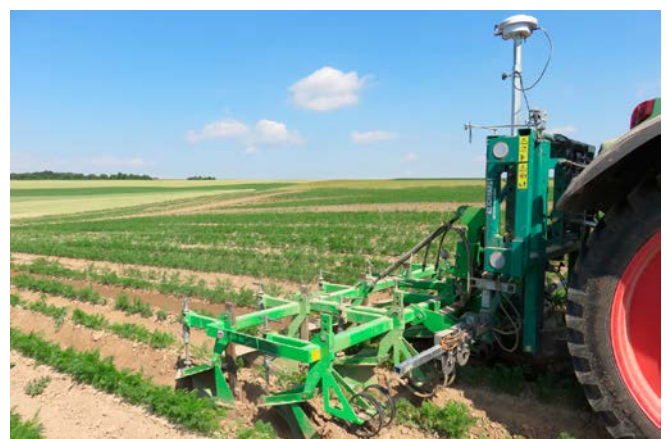
Bild 5: Entlang von Fahrspuren, Pflanzenreihen oder Dämmen kann mithilfe der Ultraschallsteuerung mit einer Präzision von bis zu drei Zentimetern gefahren werden. (Foto: Sabine Staub)
