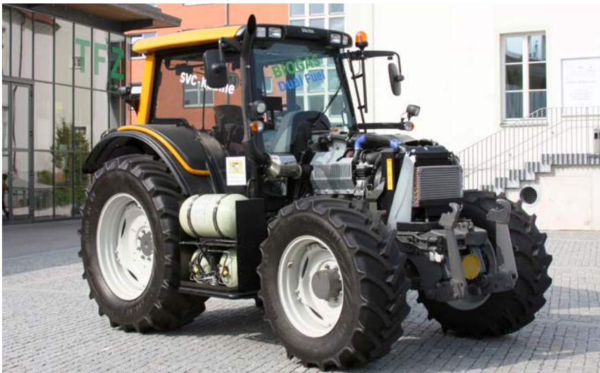
▭ Bild 2: Valtra N101 Hi Tech (Dual-Fuel-Traktor) mit abmontierter Verkleidung der Gastanks. (Foto: Peter Emberger, TFZ)
