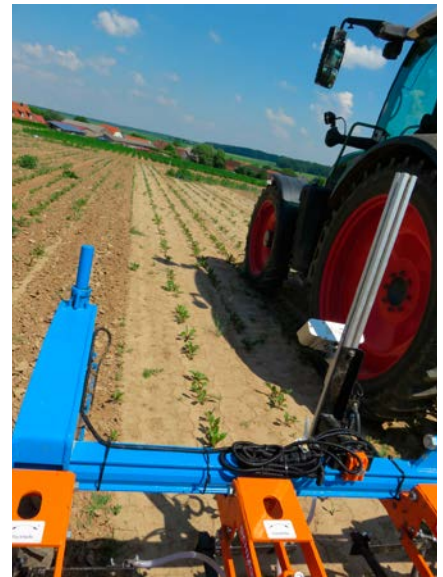
Bild 4: Die an der Hacktechnik verbaute Kamera kann bis zu drei Reihen erkennen. (Foto: Sabine Staub)
