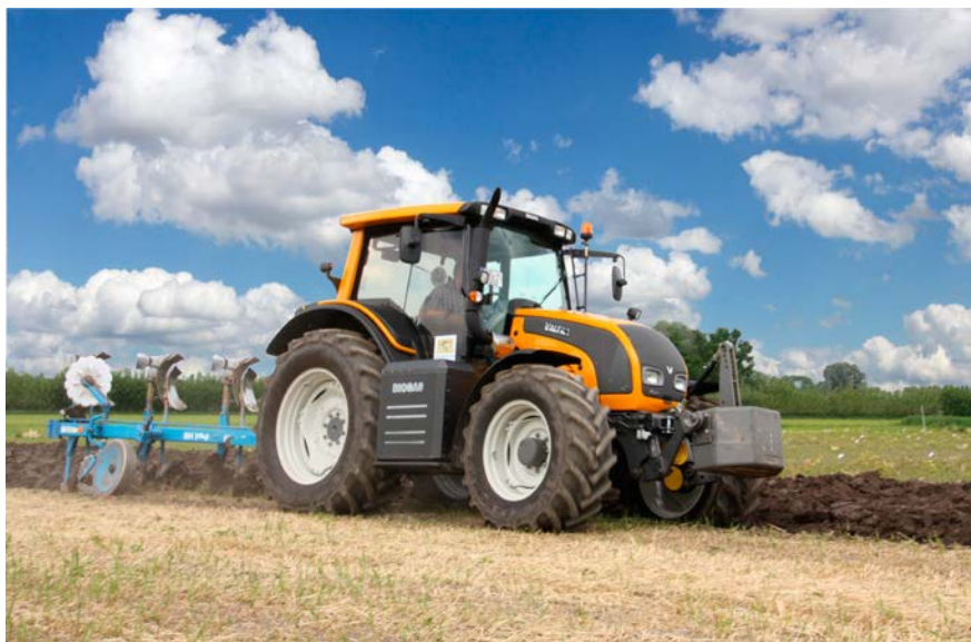
Bild 1: Valtra N101 Hi Tech (Dual-Fuel-Traktor) im Feldeinsatz auf einem Versuchsgut der Landesanstalt für Landwirtschaft in Freising. (Foto: Peter Emberger, TFZ)
