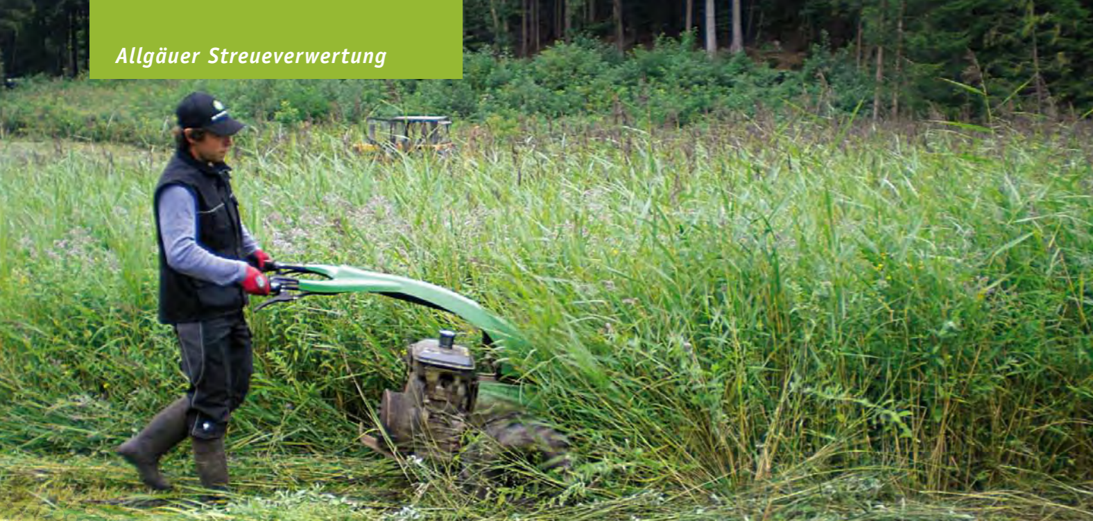
Die Maschinen für die Handmähd müssen wegen des feuchten Bodens klein und leicht sein.
