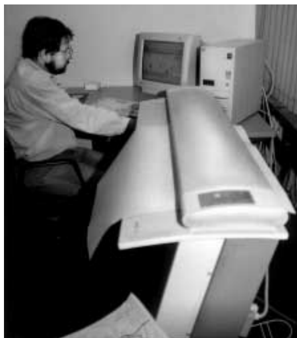
Scanner OCE mit Arbeitsplatz (Modell G6045-S im A0-Format, Auflösung max. 800 dpi)
