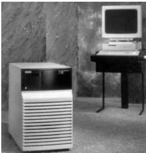
DEC AlphaServer 2100 A500MP (RISC-CPU 190 MHz, Arbeitsspeicher 640 MB, Plattenspeicher 2 x 2 GB)
