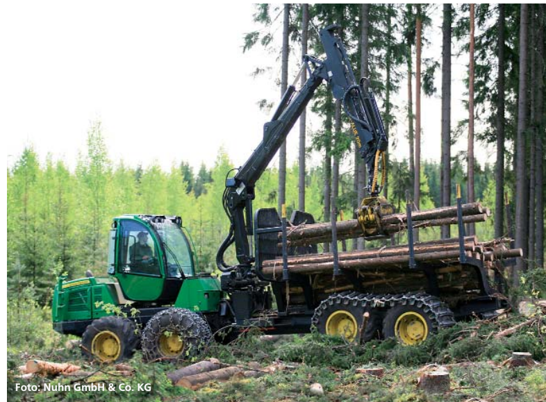
Abbildung 3: Forwarder sind aus der Forstwirtschaft nicht mehr wegzudenken. Niederdruckbreitreifen und Bogiebänder können jedoch Bodenschäden reduzieren.
